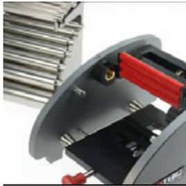
1. Öffnen Sie das Gerät ausreichend, indem Sie den Handgriff des Druckbügels gegen den Uhrzeigersinn drehen, und legen Sie dann den Dorn mit dem richtigen Durchmesser ein.
