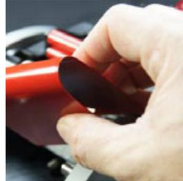
4. Drehen Sie den Hebel gegen den Uhrzeigersinn und geben Sie das Prüfblech frei. Untersuchen Sie sofort die Beschichtung in dieser Position auf mögliches Versagen.
