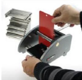
2. Klemmen Sie das Prüfblech aufrecht mit dem Anpressbügel durch Drehung des Rades fest. Während der Biegung soll die lackierte Seite des Prüfblechs nach außen zeigen.
