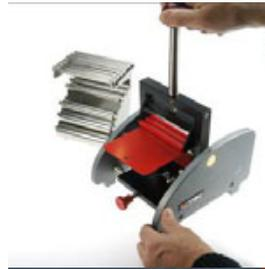
3. Biegen Sie das Prüfblech in einer gleichmäßigen Bewegung (1-2 Sekunde) bis zum Anschlag (180°).
